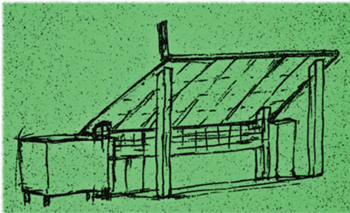
Les 22m<sup>2</sup> de panneaux solaires servent directement de toiture, installés sur une charpente métallique ou en bois selon les possibilités de la région. La face inférieure assure un matelas d'air qui circule librement par convection et assure le refroidissement naturel du panneau. (Cet air chaud peut éventuellement être récupéré pour réchauffer des tubulures pour une production d'eau chaude.)
