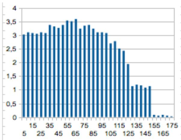
Chaque mesure de vitesse (moyenne sur 6mn ou sur 1h) incrémente le barreau correspondant, en pourcentage du nombre total de mesures déjà faites. Par exemple, le diagramme permet de voir que la vitesse du vent est 3% du temps entre 15 et 20 km/h et 1% du temps entre 120 et 150 km/ et presque jamais au-delà de 120 km/h.
