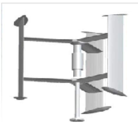
comportement face aux grandes vagues qui pourraient attaquer les pales et pour les contraintes du tangage et du roulis . Un rotor à axe vertical serait peut-être moins sensible qu'un rotor tripale classique. La puissance d'une [surface balayée de 6m<sup>2</sup>](#) pour 20km/h de vent est d'environ 500 W, soit 12kWh/jour et 120 kWh/jour pour une dizaine de mâts (l'espacement entre éoliennes doit être plus grand que l'espacement entre mâts oscillants).
