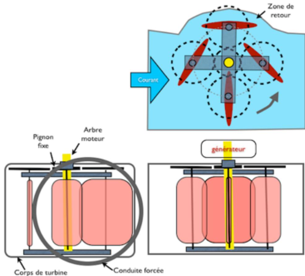
La conduite forcée est constituée de cylindres droits ou cintrés, en matériau composite moins rigide que l'acier, s'emboîtant les uns dans les autres (plutôt qu'un joint circulaire avec visserie multiple). La pression de l'eau contribue à plaquer les deux parties coniques entre elles.
