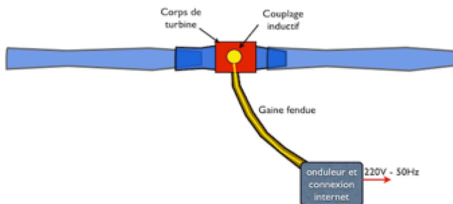
sans contact, par couplage inductif. Ce système permet un branchement de sécurité et la complète indépendance du câble de sortie. La gaine possède une fente d'extraction longitudinale permettant de sortir le câble avec sa bobine d'induction.
