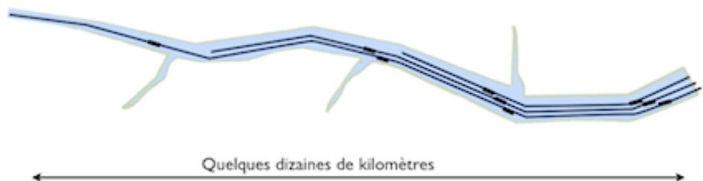
conduite plus bas, etc... Ces mises en parallèle permettent aussi de limiter le diamètre des conduites pour une meilleure résistance aux pressions et pour limiter l'engagement de la hauteur d'eau libre. Le cas échéant, le trajet d'une conduite peut court-circuiter un méandre afin d'augmenter la vitesse de l'eau forcée.
